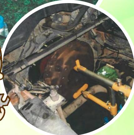
最近の車両はプロペラシャフトなどの構成部品が多く、脱着の際は二人での作業になるため一人でも作業が出来るように補助工具を探し新たに購入しました。これによりフライホイールやクラッチカバーも一人で脱着でき、腰への負担軽減や脱着時の事故防止、部品の破損防止にもつながると思います。
