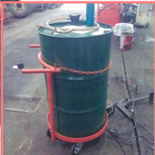
オイル交換時にドラム缶に交換する際に移動を楽にするため、今回ドラム缶の寸法を測り、移動台の製作をしました。更に燃料タンク修理時などにタンクを降ろして保管したり、燃料を抜く際に移動が楽になる台もつくりました。これによって作業時間も少しではあるが短縮も出来、場所も取らないので工場の美化に貢献出来ました。
